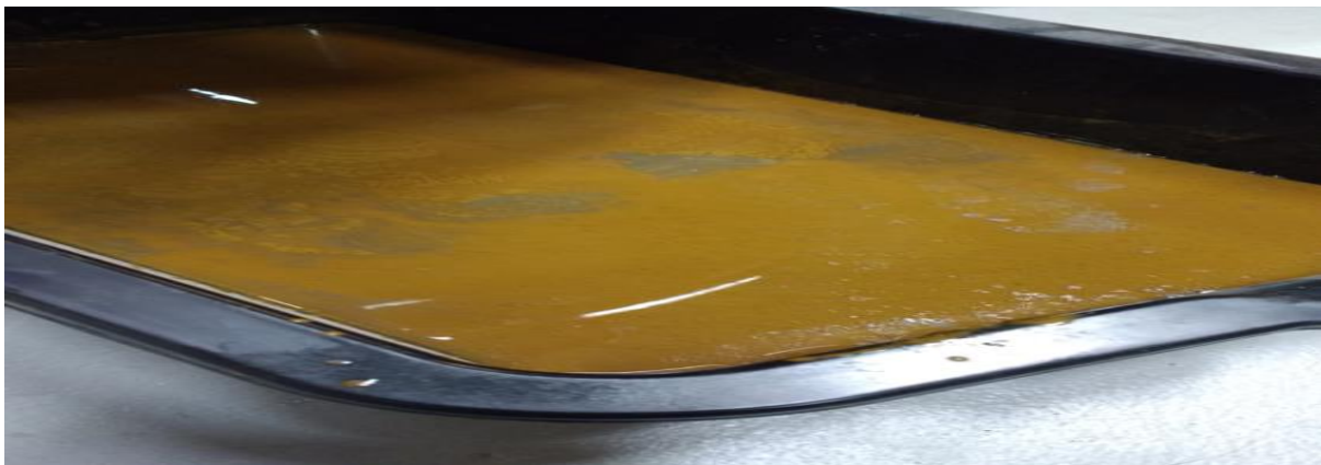
15 liter zwaar verontreinigd roestwater uit een 50 liter compressor, dus dan was het eigenlijk een 35 liter compressor.
